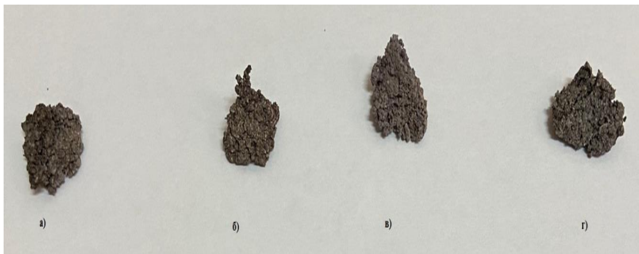
Рисунок 5 – Продукты синтеза на основе вскрышных пород Жайремского месторождения после: а) сушки на воздухе, спекания при температурах: б) 200^\circ\text{C} , в) 400^\circ\text{C} и г) 600^\circ\text{C} .
